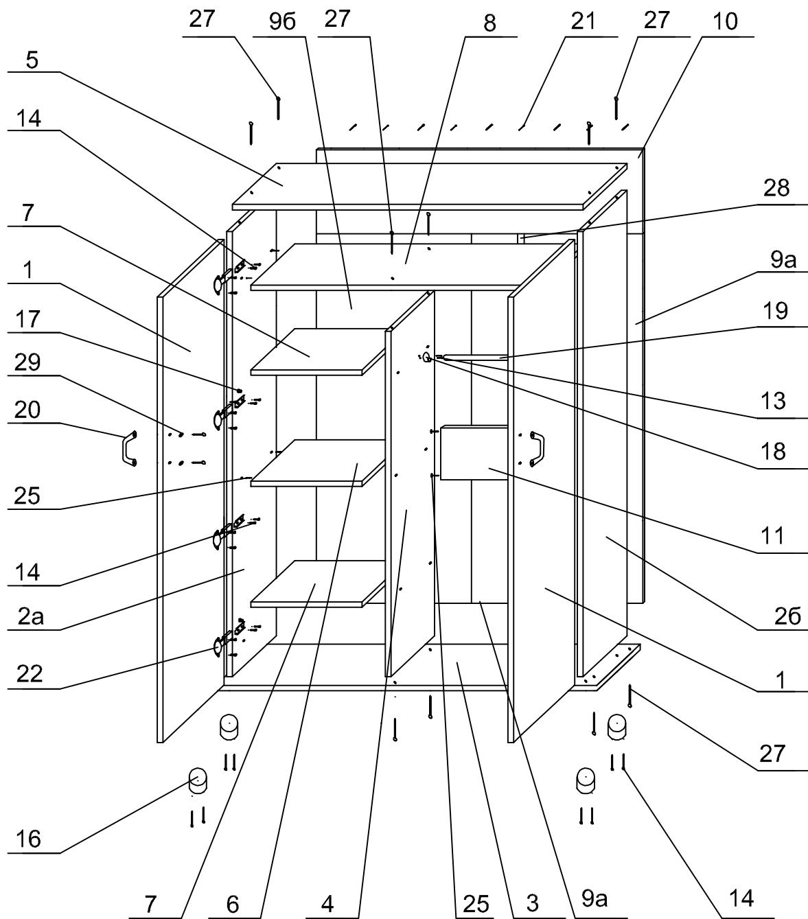
Рис.1 Схема сборки шкафа
