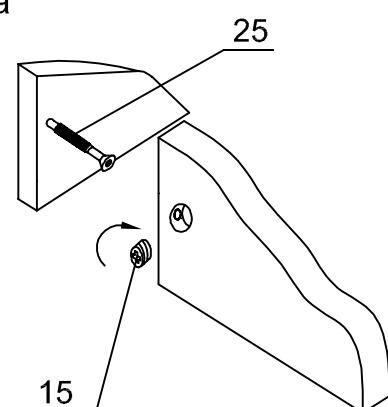
Рис.3 Соединение деталей эксцентриком
