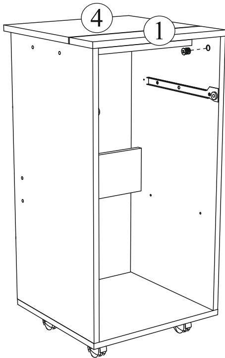
6. Подготовленные крышки 1 и 4 скрепить с боковинами 3 и 5 эксцентриковыми стяжками и зафиксировать их.
