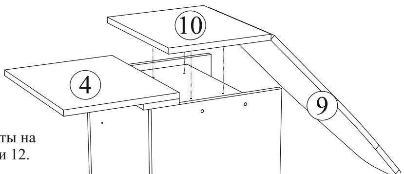
9. На створки 11 и 12 установить накладные петли шурупами оцинкованными 4x16 мм. Установить створки 11 и 12 на боковину 5, вдев накладные петли в ответные планки и затянув винты на самой петле. Отрегулировать зазоры у створок 11 и 12. Далее установить ручки саморезом.
