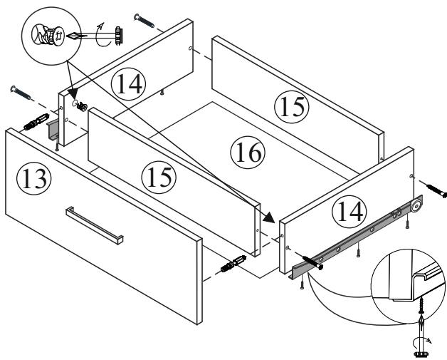
**ВНИМАНИЕ!** Направляющие прикручиваются к торцу боковин ящиков снизу, направляющее колесо должно находиться сзади корпуса ящика.
