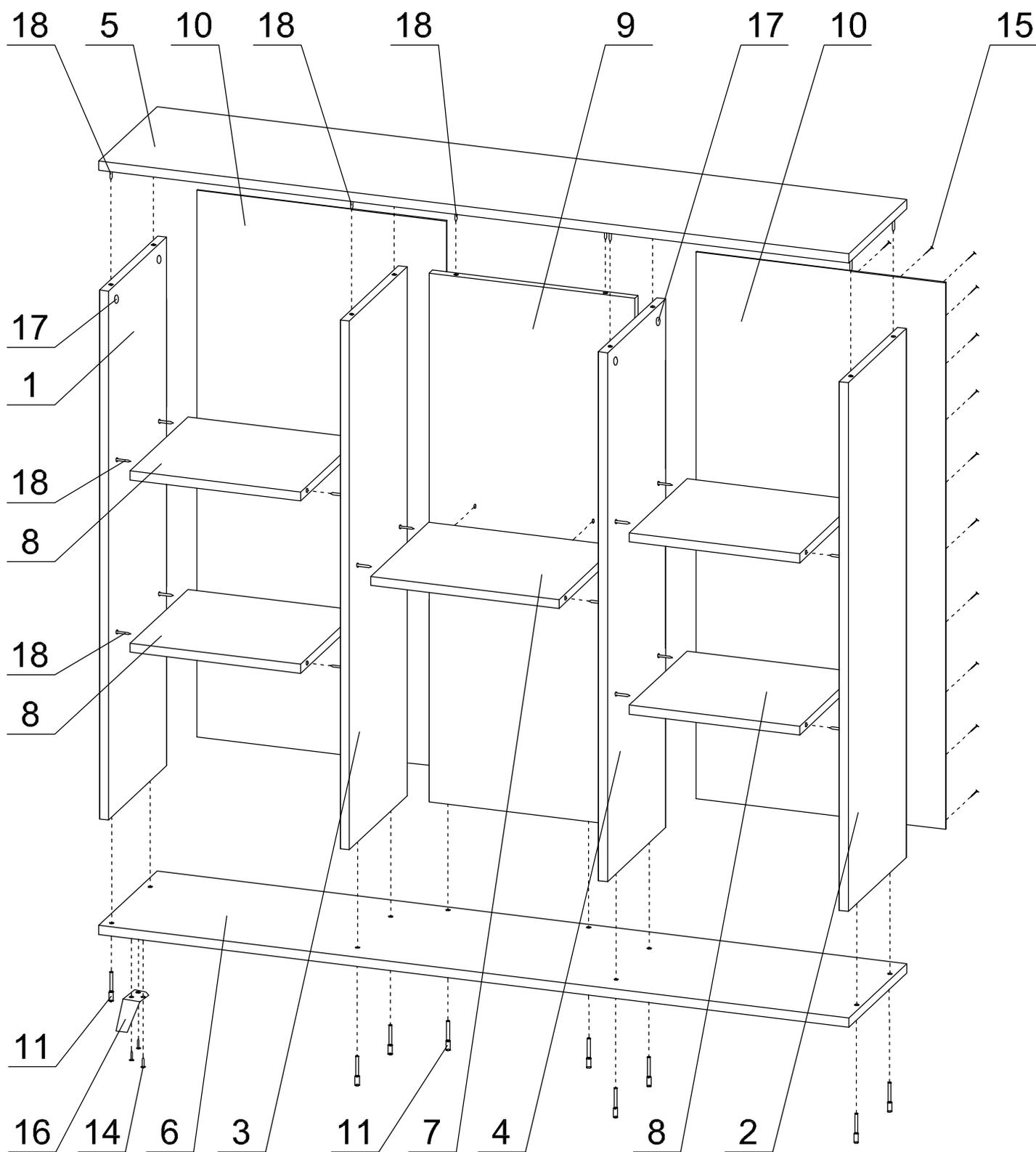
Рис.1 Схема сборки шкафа
