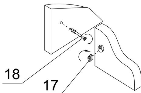
Рис.2 Крепление деталей эксцентриками
