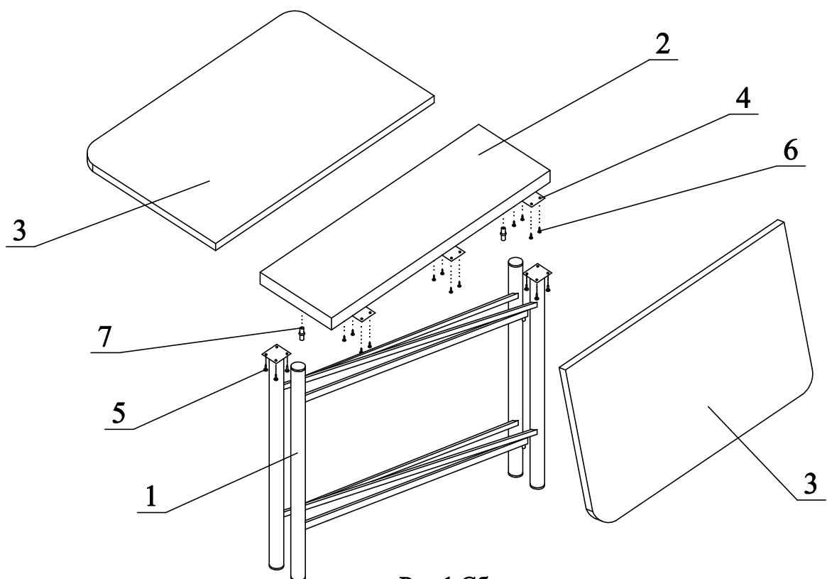
Рис.1 Сборка стола
